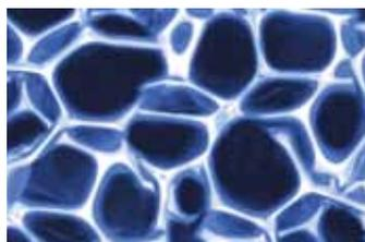
La schiuma EOS è formata da una struttura micro cellulare aperta molto fine, le cui cellule creano una superficie globale estremamente compatta, confortevole ed elastica. Filtra e dissipa l'umidità molto velocemente grazie alla sua alta permeabilità all'aria; resistente e duratura contro la compressione, decisamente leggera e facile da maneggiare.
